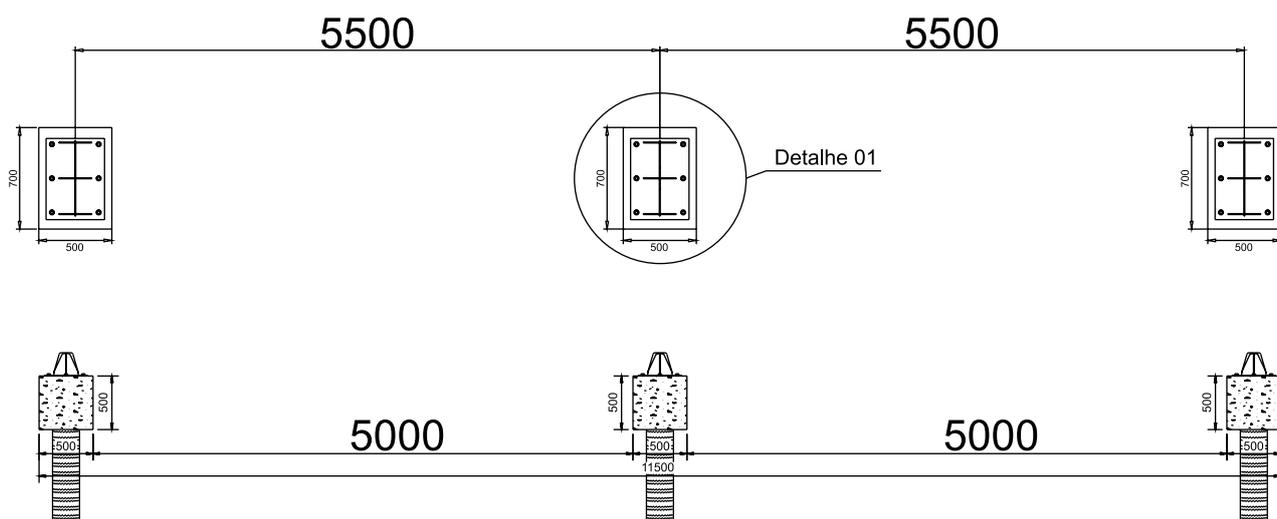
**IMPORTANTE:** As bases de concreto devem estar totalmente niveladas e alinhadas, pois, do contrário, podem comprometer o processo de montagem e, principalmente, a garantia da estrutura.
