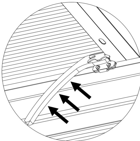
A leve pressão aplicada, além de manter o módulo na posição correta, gera o rompimento do anodizado do alumínio (detalhe 10), proporcionando uma melhora no sistema de aterramento.
