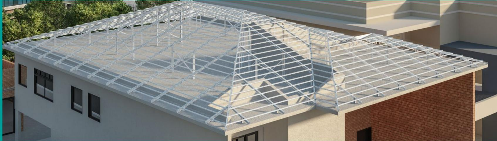
**ESTRUCTURA METÁLICA PARA TEJADO**
